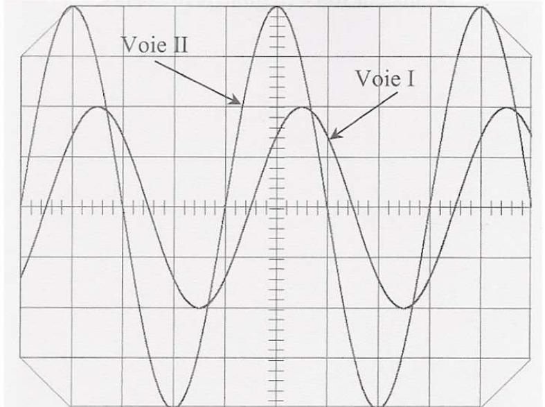
1) L'oscillogramme permet de calculer les valeurs de la période  $T$ , de la pulsation  $\omega$ , des amplitudes  $U_m$  et  $I_m$ , et de l'impédance  $Z_{AB}$  (module de l'impédance complexe du dipôle AB). Déterminer ces valeurs numériques et recopier, en le complétant, le tableau qui suit.
